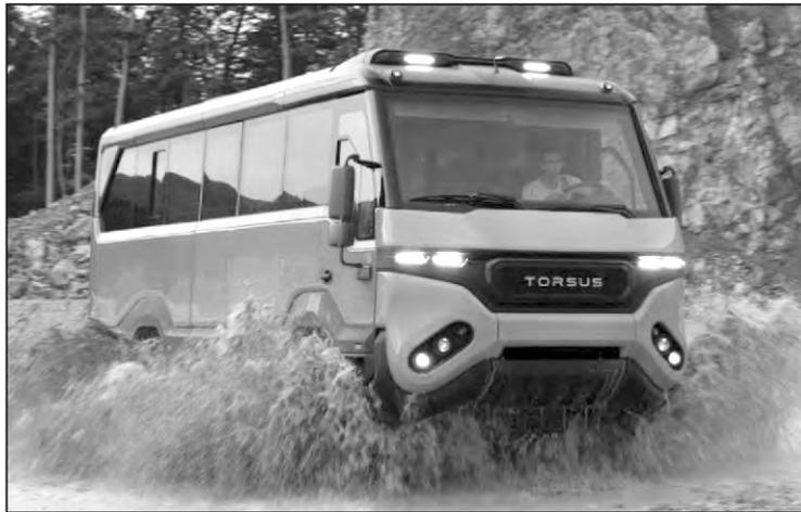
**ÔNIBUS MALUCO** - Sediada na República Tcheca, a fabricante de veículos comerciais Torsus apresentou a família Praetorian TG3, um miniônibus off road equipado com chassi MAN 4x4. O motor é um turbodiesel de 6.9 litros, que rende 290 cv de potência. O utilitário é capaz de transportar 35 passageiros com muito conforto, graças a suspensão a ar. Na Europa o TG3 custa cerca de 226 mil euros ou aproximadamente R\$1,3 milhão.
